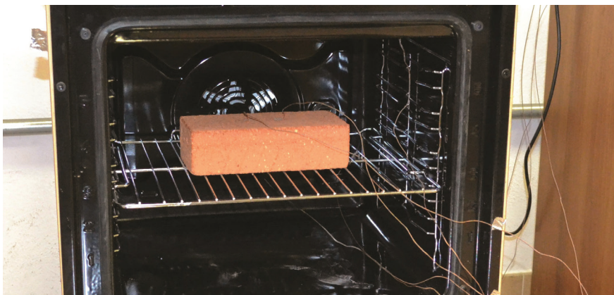
图 1 正在进行“砖块测试”的惠而浦 Minerva 烤箱。
