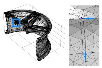
该区域中的短边形成一个小面,您可以使用*塌陷边*操作将其移除。通过将长条面的长边添加到几何序列中现有的"忽略边 1"操作,可以将其移除。
