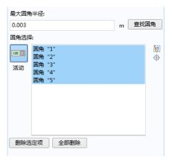
完成操作并移除圆角后,请注意,"删除圆角 1 (dfi1)"节点已插入几何序列中,位于"端盖面 1 (cap1)"节点上方。"端盖面 1 (cap1)"节点仍不可用,表示当前还未构建。
