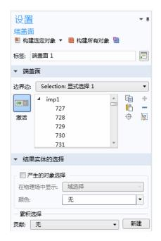
3 单击"构建选定对象" ⋒ 按钮以完成操作。 该操作使用新的面封闭了入口和出口。同时还创建了一个固体域,即排气歧 管内部的原始空区域。
