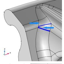
"图形"窗口中的轮辋可视化显示会更新,以反映选定的边和相邻顶点(如果有)都不再属于要划分网格的几何。
