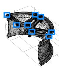
4 使用 "缩放框" 按钮,放大辐条与轮辋连接的区域,如下图所示。 每个辐条都包含由小特征引起的密集网格区域,如图中箭头标示的区域。
