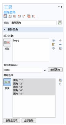
5 该工具找到了五个圆角。它们显示在"圆角选择"列表中,并在几何图形中 突出显示。
