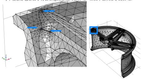
通过仔细观察可以发现,该区域中的多条边被突出显示,提示对于当前网格设置,它们太短而无法进行网格划分。
