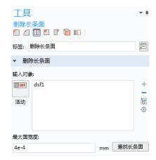
该工具通过将长条面塌陷成一条边来将其移除,在此过程中使用的是搜索时指定的容差。要得到最佳结果,容差需要接近已删除面的实际宽度。如果发生长条面无法删除的情况,您可以编辑操作的设置,以设置一个略大于面宽度的容差。
