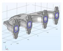
这些边可以直接在"端盖面"操作中选定,但更有效的一种方式只需从每个边 环中选择一段,此方法使用显式选择,您可以通过选项在选择中自动包含连续 边。
