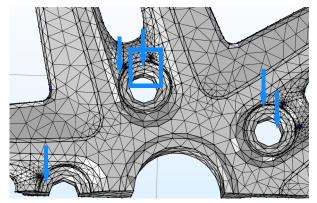
图中用箭头标示的密集网格区域是由于存在长条面和小面而产生的。进一步放大蓝色三角形区域,可以看到长条面旁边有一个小三角面。每个螺栓孔位置周围都有这样两个小三角面。蓝色突出显示的边显示在"警告"窗口的"选择"列表中。要获取这些面的代表性尺寸,您可以测量其中一条边的长度,例如列表中的编号 646,即右图中箭头标记的边。
