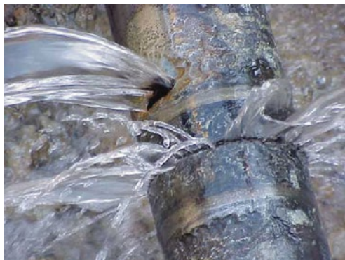
图 1. 左图: 检测中的泄漏管道; 右图: 泄漏检测设置示意图。泄漏点位于间距为 D 的两个传感器之间。泄漏噪声沿两个方向传播, 相关仪测量了声音到达每个传感器所需的时间。根据管道中的声速, 即可推算出确切的泄漏位置。图注: Sensor - 传感器; RF Transmitter - 射频发射器; Cross-correlator - 互相关仪
