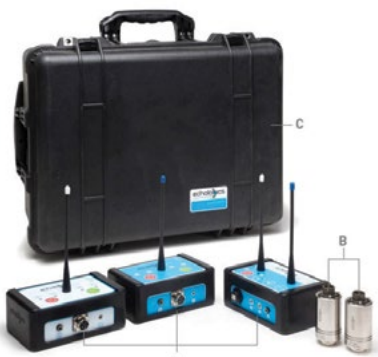
图 2. LeakFinderST™ 相关仪是一款简单易用、体积小巧的泄漏噪声相关仪。
