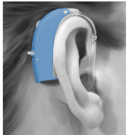
图 1. 标准的耳背式助听器由麦克风、隔振装置、受话器等元件组成。由于元件布局过于紧凑, 容易产生负面的声学 and 力学反馈。图片由楼氏电子公司提供。图注: MICROPHONES - 麦克风; VIBRATION INSULATION - 隔振装置; RECEIVER - 受话器
