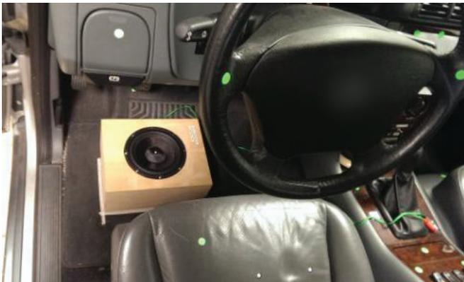
ABBILDUNG 1. Lautsprecherpositionierung im Fahrzeuginnenraum.
