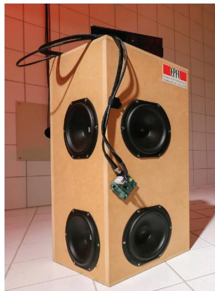
РИС. 1. Прототип электроакустического резонатора. Изображение предоставлено: EPFL / Ален Герцог.
