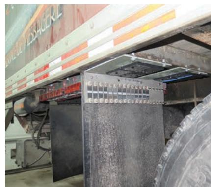
**РИС. 2.** Вверху: гальваническое коррозионное повреждение на перекрытии в многокомпонентной сборке, выполненной из армированного углеродным волокном полимера (CFRP) и алюминиевого сплава серии 6000, после одного года эксплуатации на транспортном средстве. Внизу: типичное положение образцов на транспортном средстве для проведения эксплуатационных испытаний.
