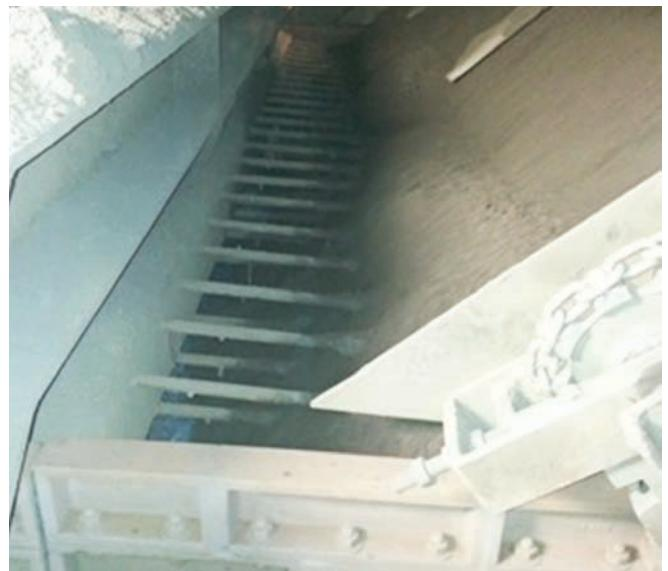
**РИС. 5.** Система подачи смеси в агломерационной установке с двумя рядами горизонтальных стержней проницаемости.
