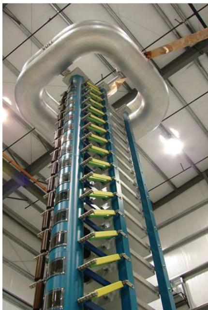
**РИС. 1.** Высоковольтный генератор (генератор Маркса на 2,4 МВ), используемый в компании NTS.
