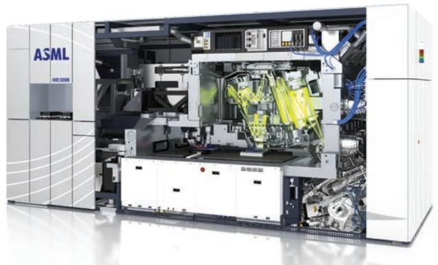
**РИС. 2.** Готовая к работе система литографии компании ASML® TWINSCAN® NXE:3350B на основе глубокого ультрафиолетового излучения производит 125 компьютерных пластин в час при облучении на частоте 13,5 нм. Необходимо поддерживать идеальный вакуум при перемещении пластин на высоких скоростях и нагрузках, чтобы искажения не превышали 1 нм.
