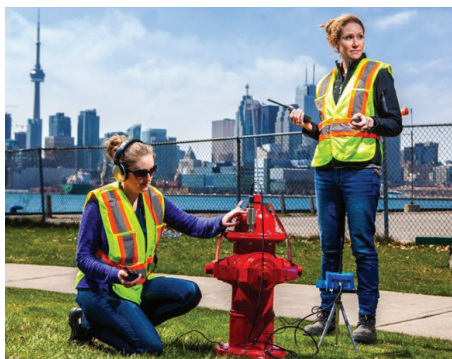
図 2. LEAKFINDERST™ 相関器は、コンパクトで直感的なリークノイズ相関器です。
