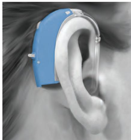
図1. 典型的な耳かけ型（BTE）補聴器は、マイク、振動遮蔽部、レシーバ等によって構成されます。これらのコンポーネントが小さな空間に詰め込まれていることは、厄介な音響および機械的フィードバックを招きます。（写真提供：Knowles Corp.）
