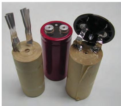
図 1. アルミ電解コンデンサ。コイルは、アルミ箔とセルロース系セパレータから構成され、熱異方性を呈します。
