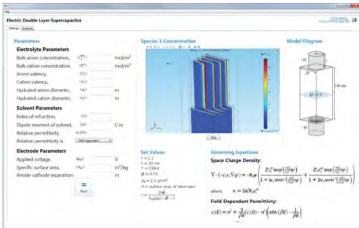
図 2. EDLC の解析に用いたアプリケーションの一部を示すスクリーンショット
