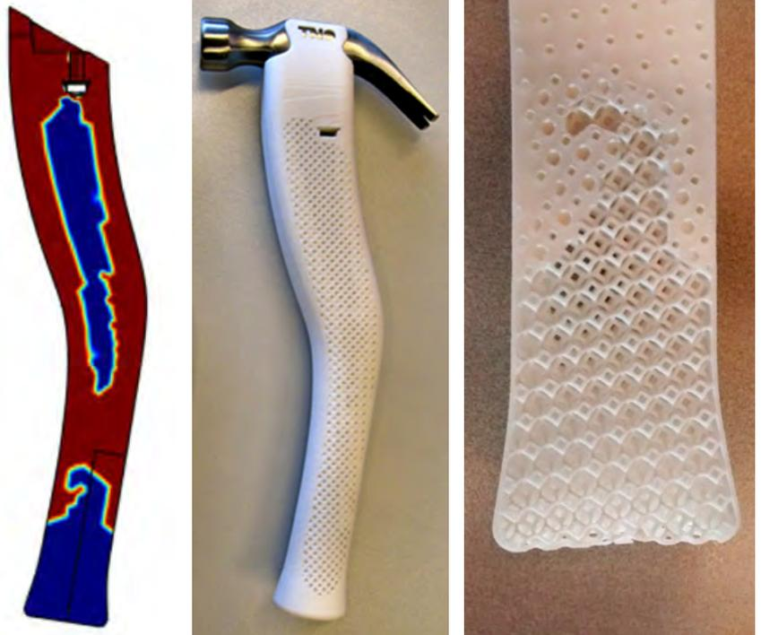
図 5. 左：COMSOL ソフトウェアでのトポロジー最適化の結果 中央：ナイロンでプリントされた最適化ハンマーの柄 右：3 種類の異なるセル型を含むパターンをクローズアップ：上部の近くで小さな穴を持つ高密度セルと下部方向に低密度セルがあり、その間に僅かながら中間体がある。
