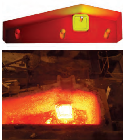
図 3. COMSOL Multiphysics の CFD モジュールを使用してタンディッシュモデル（上）と中身が空の実際のタンディッシュ（下）
