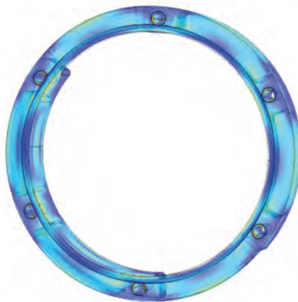
図 2. シミュレートされた装置の回転テスト。ボルトの位置に集中している遠心力によって誘発される圧力を示しています。
