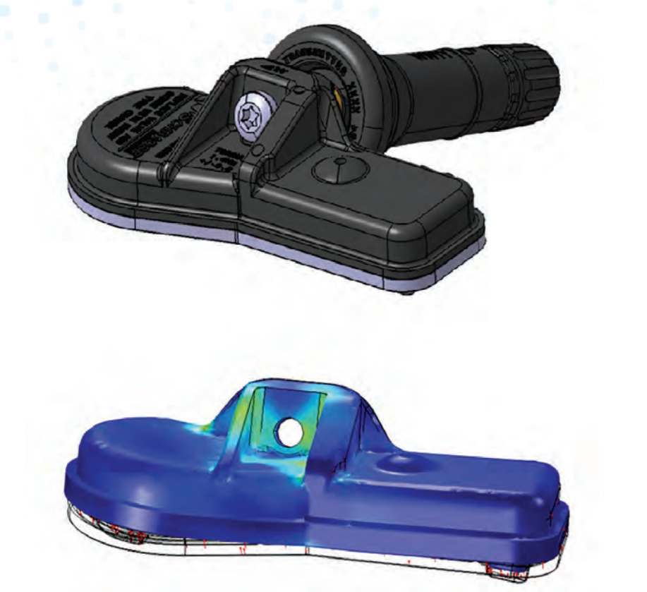
図 1. 上 : 高速内蔵タイヤ圧力監視センサ (Hi-Speed Snap-In Tire Pressure Monitoring Sensor:TPMS) は、タイヤ圧力を監視し、測定情報を送信します。
