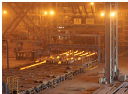
図 1. 連続 casting 法の排出テーブル。凝固ストランドが切断、排出されています。
