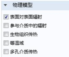
默认情况下，辐射方向由域的不透明度控制。固体部分定义为不透明，流体部分则为透明。通过在“固体”和“流体”节点中修改或添加“不透明”子节点，可以更改这些设置。
